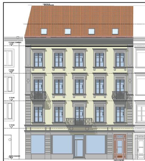
Plan d'élévation de la façade sur rue après rénovation, avec vue des 4 nouveaux velux et de la nouvelle porte – Martin Plattner dipl. architecte
